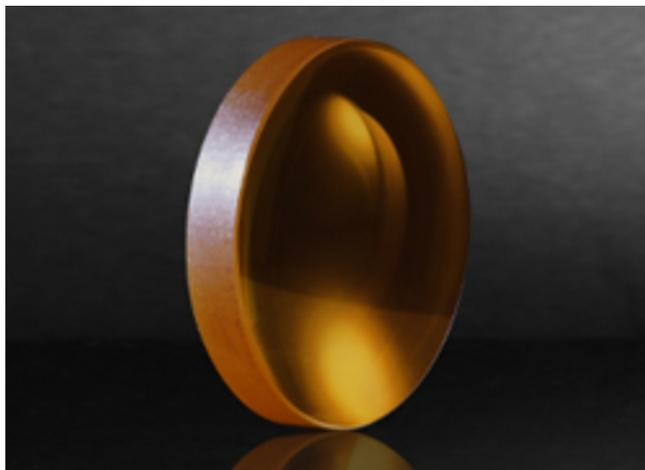
Плосковогнутые линзы из селенида цинка имеют отрицательное фокусное расстояние и могут быть использованы для коллимации излучения из мнимого источника. В частности, они используются в расширителях пучка. Подходят для работы с излучением 0,6-16 мкм.
