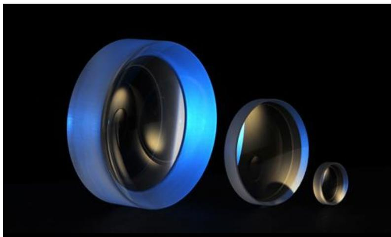
Плосковогнутые линзы из фторида кальция имеют отрицательное фокусное расстояние и используются для коллимации излучения из мнимого фокуса. В частности, такие линзы используются в расширителях пучка. Подходят для работы с излучением 200-7000 нм.
