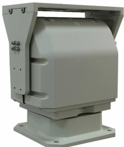
LC-H100 — это ОПУ тяжёлого типа, корпус которого изготовлен из высокопрочного алюминиевого сплава, а поворотная платформа реализована на базе червячного механизма, имеющего самоблокировку при отключении питания. Данное устройство предназначено для позиционирования крупногабаритных систем наблюдения вне помещения при различных погодных условиях.
