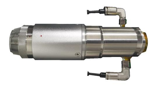
Волоконные лазерные коллиматоры просты в эксплуатации и поставляются с байонетными разъемами типа QBH и SMA для соединения с оптоволокном, встроенной системой охлаждения и широким диапазоном диаметров объектива от 12,7 до 50,8 мм и фокусных расстояний от 20 до 300 мм. Подходят для коллимации лазерного пучка в лазерных системах обработки, например, для лазерной резки и сварки, в том числе, для систем, мощностью до нескольких киловатт.
