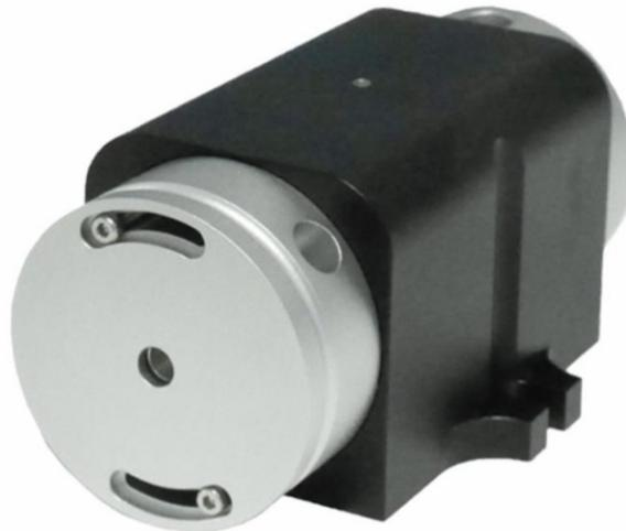
Защитные изоляторы предназначены для защиты лазера от обратного отраженного света. Изолятор обычно поворачивает плоскость поляризации на  $45^\circ$  по часовой стрелке в прямом направлении, если предпочтительна другая поляризация выходного сигнала, можно использовать волновую пластину  $\lambda/2$ . Высокая эффективность передачи, высокая степень изоляции, высокая управляемость мощностью и большая апертура диафрагмы делают его пригодным для различных применений в области лазерной защиты.
