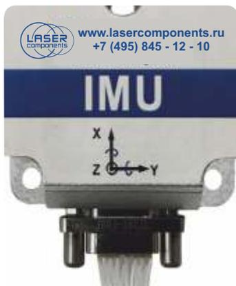
IMU100EX - это компактный инерциальный измерительный блок со встроенным трехосевым гироскопом и трехосевым акселерометром, а также источником питания с широким диапазоном рабочего напряжения и интегральной схемой обработки сигналов, который обеспечивает измерение и вывод информации о компенсированной угловой скорости, ускорении, температуре и прочих параметрах.
