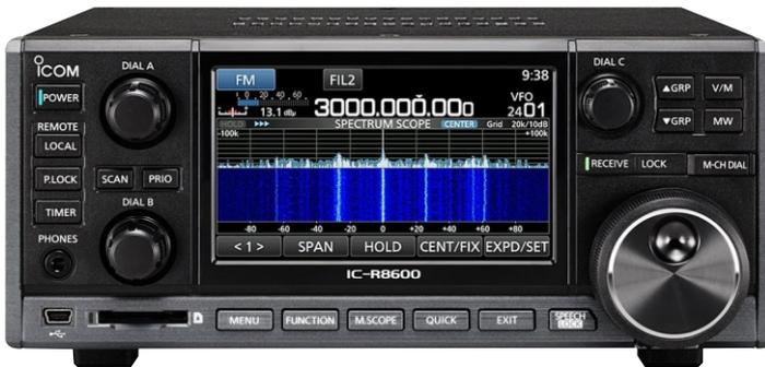
Коммуникационный приёмник IC-R8600 представляет собой широкополосный радиосканер с покрытием частотного диапазона от 10 кГц до 3 ГГц, оснащённый декодером нескольких цифровых режимов. Данный прибор отличается хорошими показателями селективности и чувствительности, а также обладает функцией удалённого контроля и передачи данных по IP сети или по USB кабелю.
